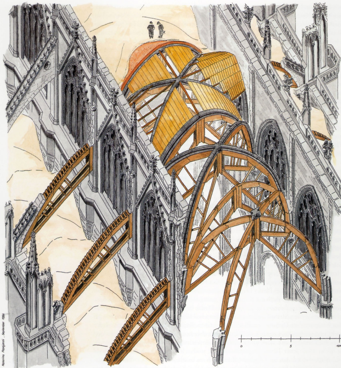
Regensburg, Dom, Wölbungsvorgang mit Lehrgerüst und Schalung, um 1300.
