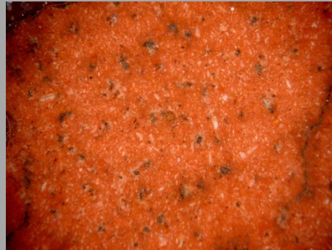
Stuckmarmor-Oberfläche Bildbreite ca. 10 mm
