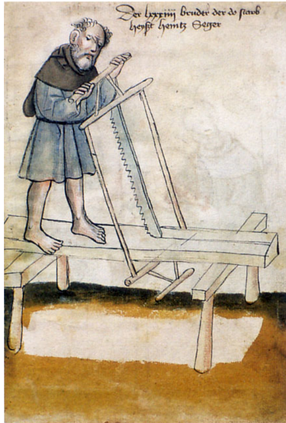
Der Säger (seger) zersägt mit einer Rahmensäge ein Kantholz, das auf zwei Böcken über einer Sägegrube liegt, in der allgemein ein zweiter Säger steht. (fol. 39r)
