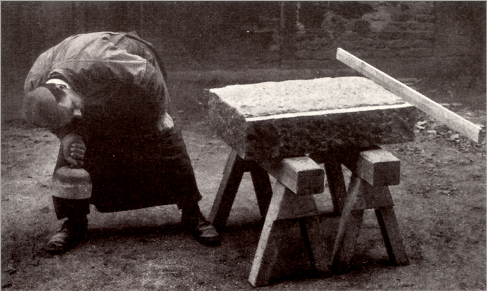
Grob zugearbeiteter Werkstein mit Randschlag.
