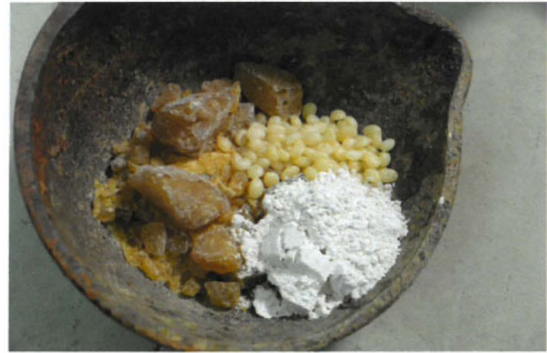
Abb. 201: Burgunderharz, Bienenwachs und Steinmehl: Rohstoffe für den Steinkleber.
