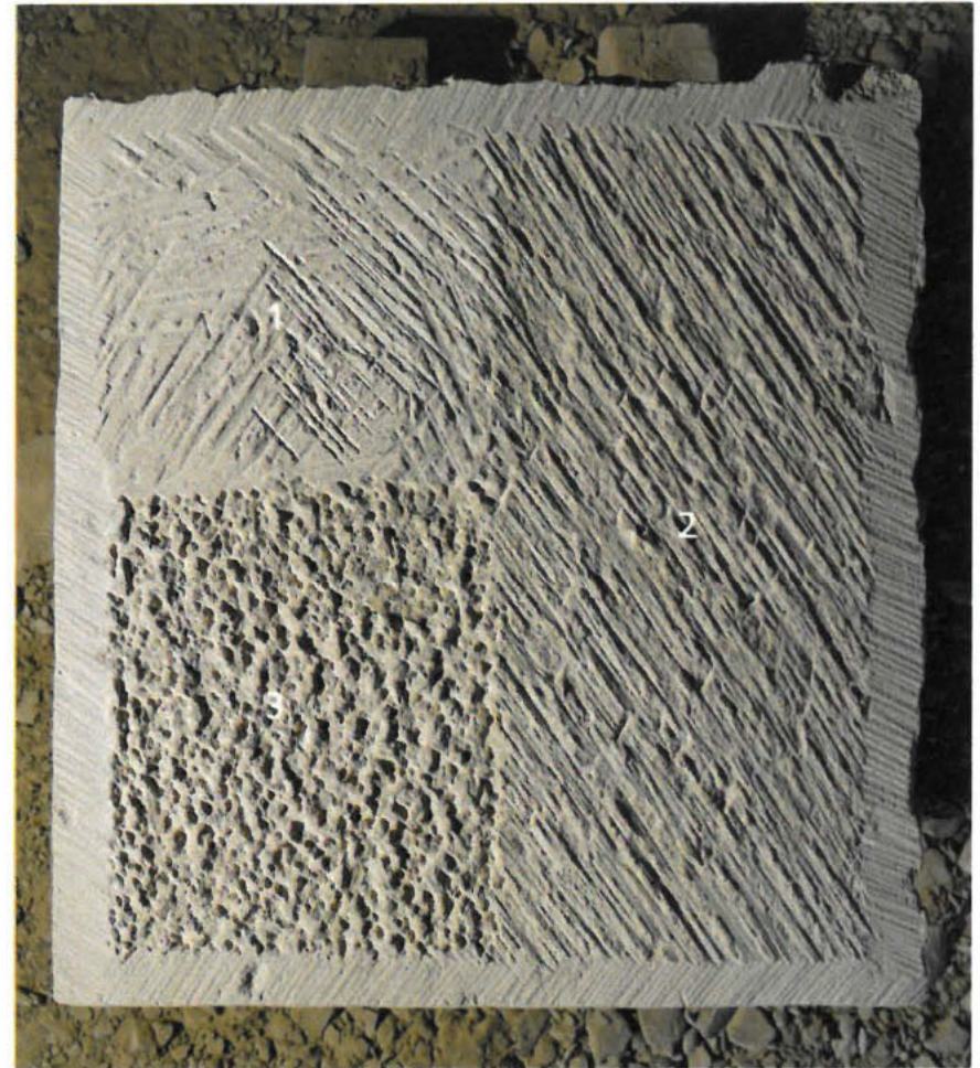
Abb. 145: 1 Abflächung, Hiebe ungeregelt | 2 Abflächung, Hiebe geregelt | 3 Pickung/Punktspitzung.
