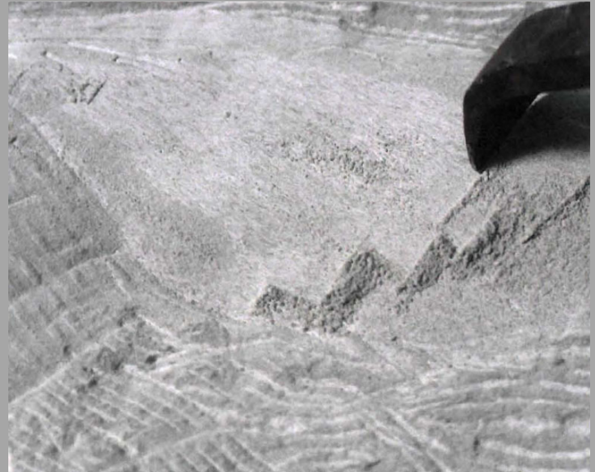
Abb. 193: Mit dem glatten Schabeisen können Oberflächen sehr fein überarbeitet werden.
