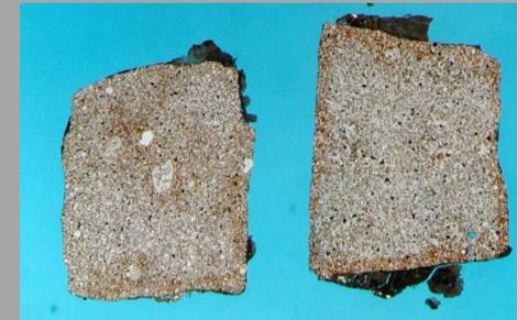
Oberflächenparalleler Korrosionshorizont, etwas dunkler im Bild, Dünnschliff, Bildbreite 1,5 mm
