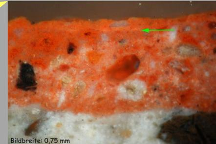
Zweischichtige, frisch gebundene Deckschicht, vermutlich Ziegelmehl Querschliff, Bildbreite 0,75 mm
