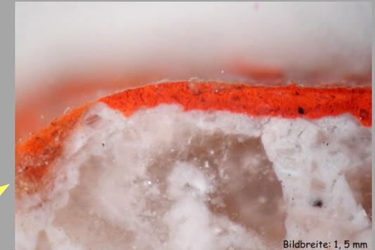
Querschliff der geglätteten und frecal einbondenen Malschicht über Glättschicht aus Marmorsplitt und Kalk,
