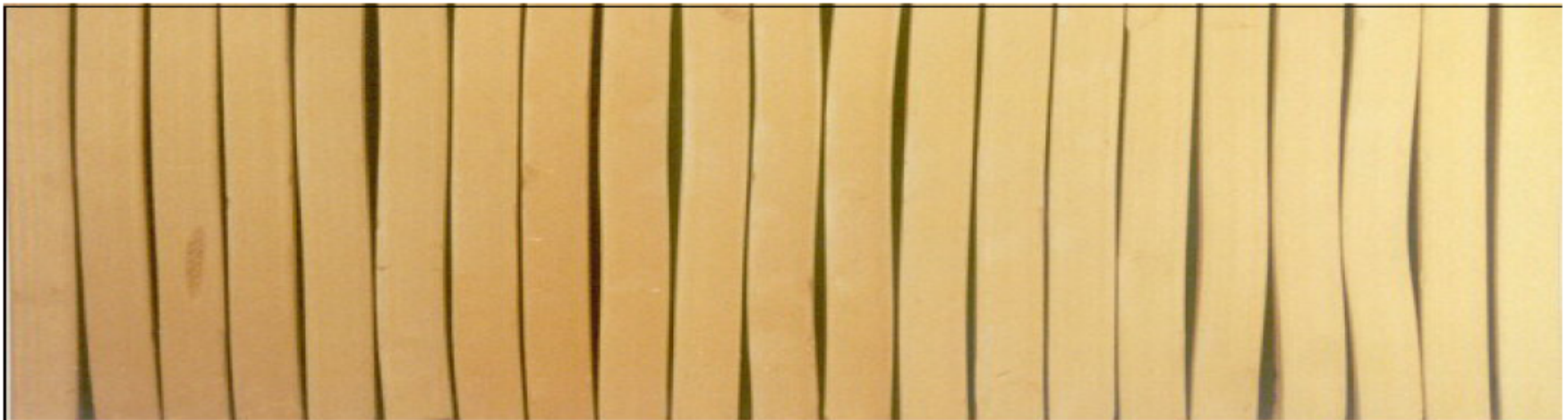
Abbildung 71: Farbentwicklung eines eisenführenden illitisch-glimmerhaltigen Tones im Sinterverlauf (Gradientenofenbrand, Foto: Freyburg)
