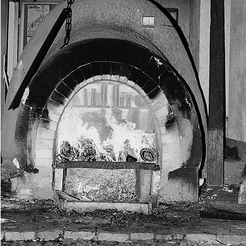
Abb. 18: Im Holzbrandofen werden die gut sichtbaren Tonobjekte im hinteren Ofenteil durch die Hitzeentwicklung des Holzfeuers im vorderen Teil des Ofens gebrannt (Foto: Michael Schacht).
